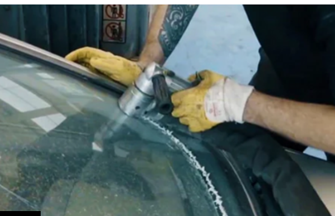
Fraise coupe verre avec unité de commande, aspirateur et réservoir.
